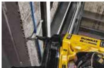
\*Quando si utilizza la chiodatrice per cemento DCN890 con prodotti come i fissatubi premium, è necessario utilizzare una punta aggiuntiva con naso magnetico (DCN8902).
